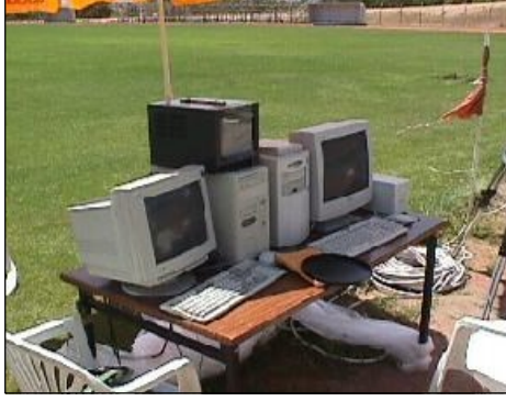
Şekil-3. CCD görüntülerinin aktarılacağı ve teleskobun kontrol edileceği bilgisayarlar, video monitörü ve kesintisiz güç kaynağından oluşan gözlem ve kontrol masası.
