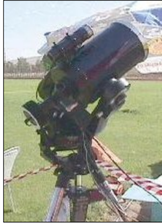
Şekil-1. Tutulma gözlemi için kullanılacak teleskop ve CCD.
