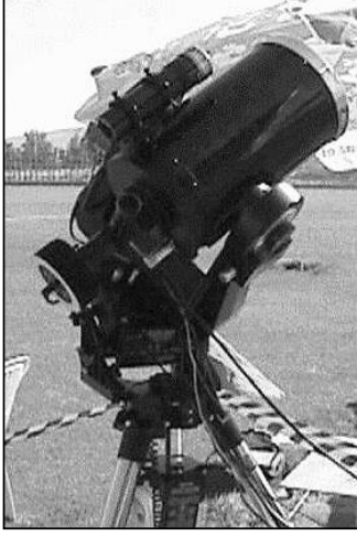
Şekil-1 Meade LX200 teleskop, CCD kamera ve kılavuz teleskopta bulunan video CCD kamera.
