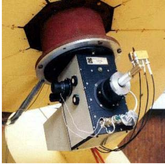
Şekil 1. RTT150 cassegrain odağında coravel
