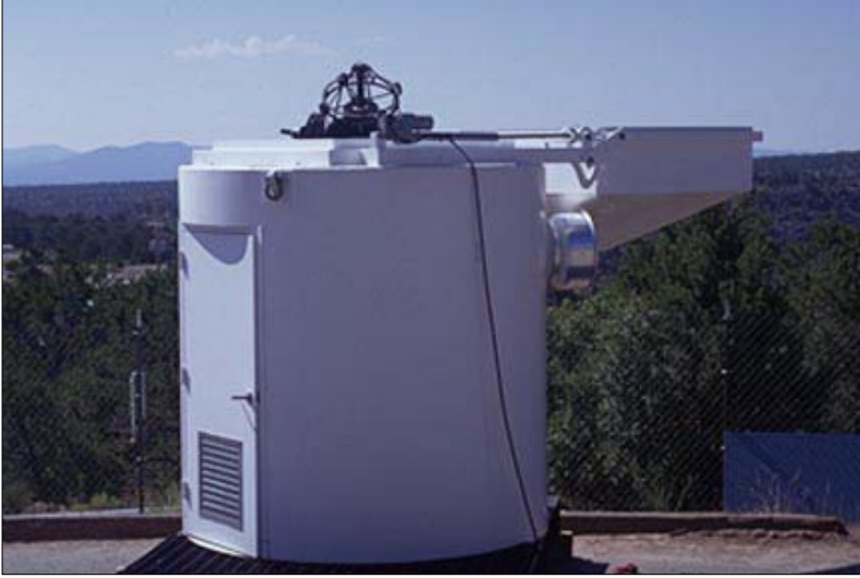
Şekil 10. ROTSE-III özel koruma sistemi içinde. 45cm'lik Teleskop iskelet çerçevesi içinde ucu çıkmış olarak görülmektedir
