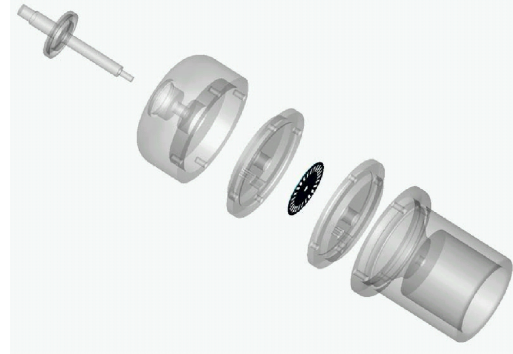
Şekil 2. Fiber tabanlı dönel kodlayıcılara ait bilgisayar destekli Yazılım çıktısı
