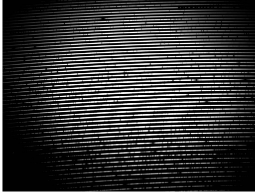
Şekil 1. R=40000 modunda, Andor 2K CCD ile alınmış gökyüzü tayfı. Üstten yedinci basamakta görülen geniş karartı, H \alpha çizgisidir. Şeklin sağ üstündeki seri ise atmosferik (tellürik) kökenlidir.
