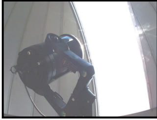
Şekil 2. 14" f/10 LX200 GPS Schmit-Cassegrain Teleskop
