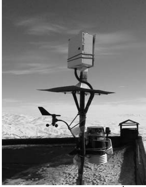
Şekil 4: TRT Verici İstasyonu'nun tarasına kurulan kablosuz meteoroloji istasyonu (sıcaklık, basınç, rüzgar hızı ve yönü, nem, yağış miktarı, güneş enerjisi ölçer) ve bulutluluk oranı ile açık gün ve gece sayısını tespit eden CCD kamera sistemi (Stellacam ve otomatik irisli balıkgözü mercek) (Şubat 2008, Foto: CY).
