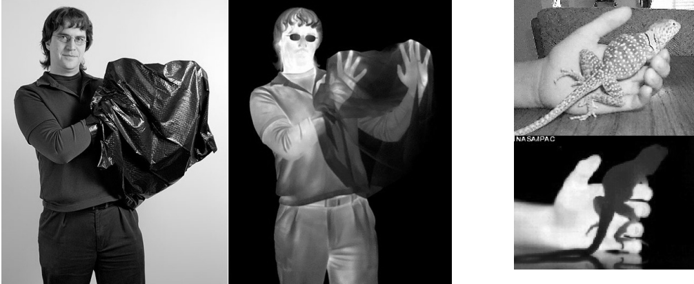
Şekil 2. Görünür ve kızılötesi bölgelerde alınmış görüntülerin karşılaştırılması. Görünür bölgede geçirgen olmayan siyah renkli torba, 7,5\text{--}13 \mu\text{m} dalgaboyu aralığına duyarlı ısı (termal) kamera ile bakıldığında şeffaf görünmektedir. Benzer şekilde gözlük camları ise kızılötesi bölgede geçirgen değildir. Sağ kolon, soğukkanlı bir kertenkelenin vücut sıcaklığının sıcakkanlı insanla farkını göstermektedir. Görüntülerin ve farklılıkların sebebi yine karacisim ışımasıdır. [1,2]
