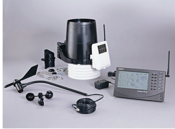
Şekil 9. http://www.davisnet.com Meteoroloji, $ 495, Bilgisayar denetimli, sıcaklık, nem, basınç, yağmur, rüzgâr ölçümleri. Uzaktan ve otomatik kullanıma elverişli, istatistik tutabilir.
