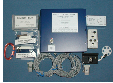
Şekil 3. Digital Dome Works http://www.homedome.com $ 1,950, Bilgisayar denetimli, tümüyle uzaktan ya da otomatik kullanıma elverişli.
